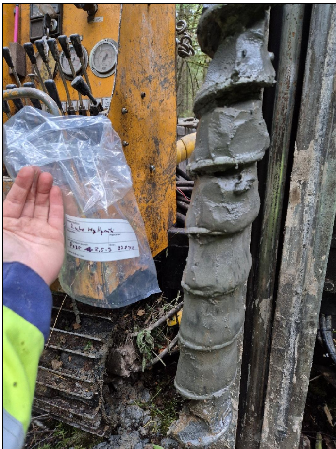
Kuva 6. Näyte "P025 2,5-3", jossa todettiin potentiaalisesti hapanta sulfaattimaata kokonaisriikki- ja hapantuottopotentiaalin perusteella.
