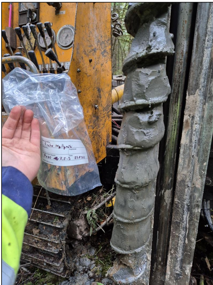
Kuva 6. Näyte "P025 2,5-3", jossa todettiin potentiaalisesti hapanta sulfaattimaata kokonaisriikki- ja hapontuottopotentiaalin perusteella.
