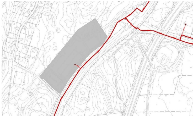
Kuva 8 Raahen Energia Oy:n kaukolämpölinja. Linja sijaitsee suoja-alueineen Rautaruukintien katualueen puolella.
