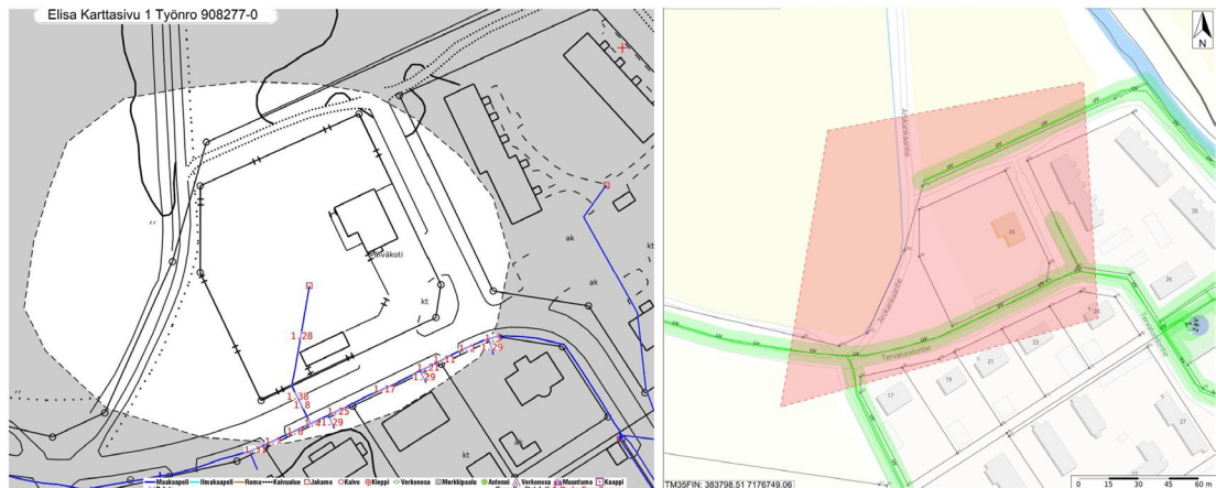
Kuva 6. Tietoliikenne- ja sähköverkot.
