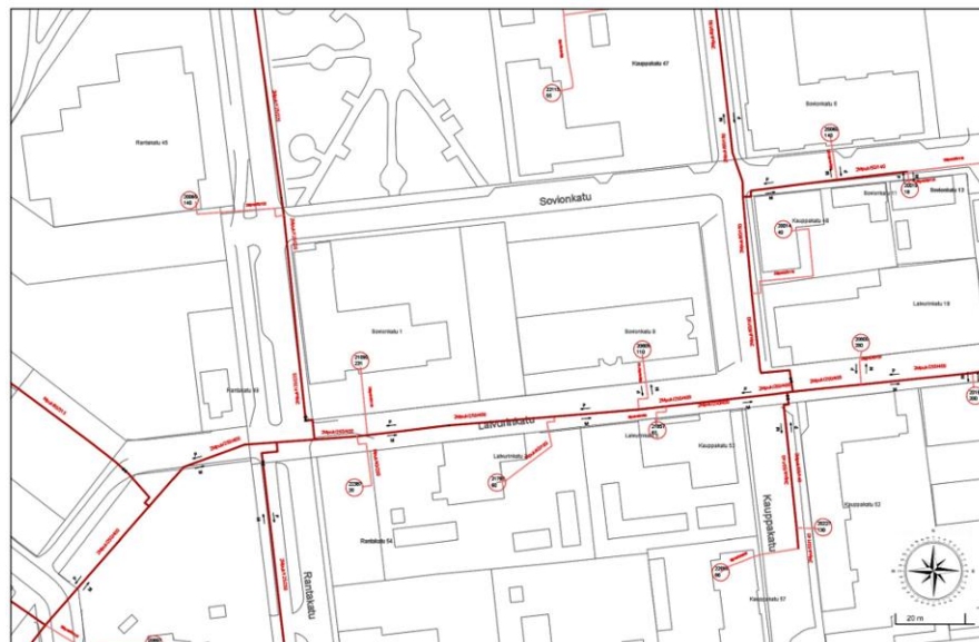
Ote Raahen Energia Oy:n kaukolämpöverkosta, 24.8.2017. Kaukolämpöverkkolinja sijoittuu Kauppakadun ja Laivurinkadun varteen.
